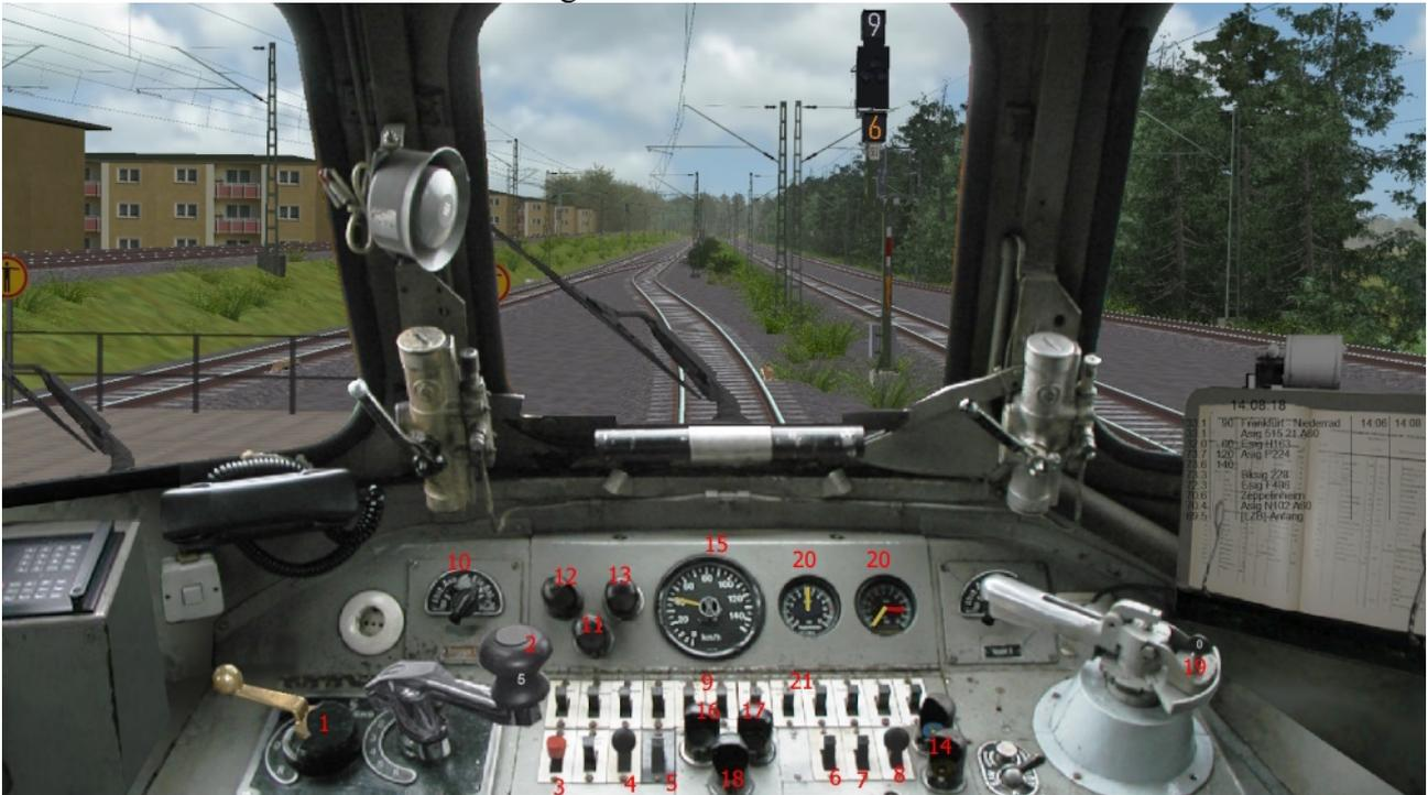
1 Richtungswender, 2 Fahrschalter, 3 Türschließung, 4 Sanden, 5 Magnetbremse, 6 Indusi Befehl, 7 Indusi Frei, 8 Indusi wachsam, 9 Spitzenlicht, 10 Anlasser, 11 LM Motor, 12 LM Schleudern, 13 LM Traktion gesperrt, 14 Indusi 60, b.z.w. PZB90, 15 Tacho, 16 LM Magnetbremse aktiv, 17 LM Schnellbremsung, 18 LM Sifa, 19 Dynamische Bremsstufe, 20 Druckanzeigen, 21 Leistung und Luftpresser( wird durch Taste Federspeicherbremse, geschaltet)
